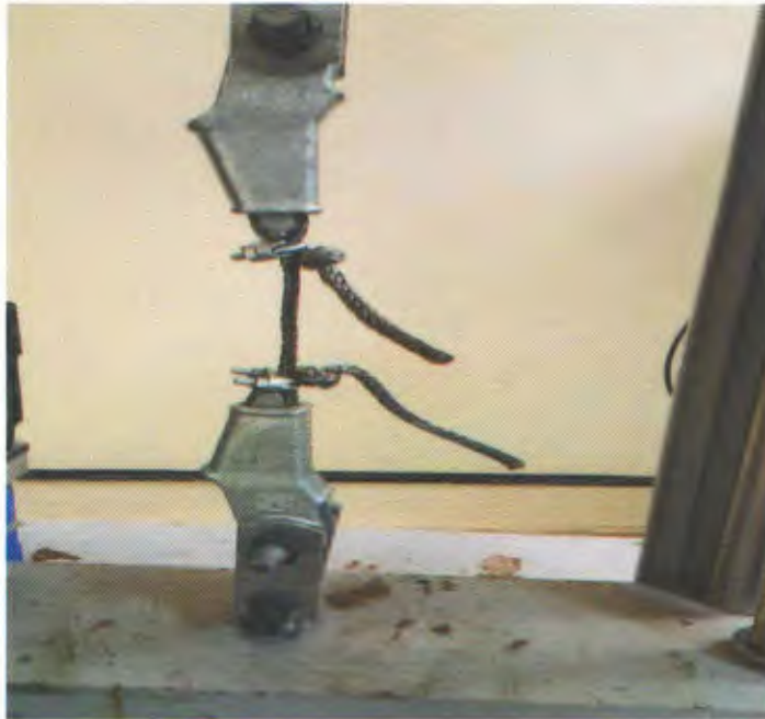
Рисунок 3 – Закрепление троса Dупеет в установке
